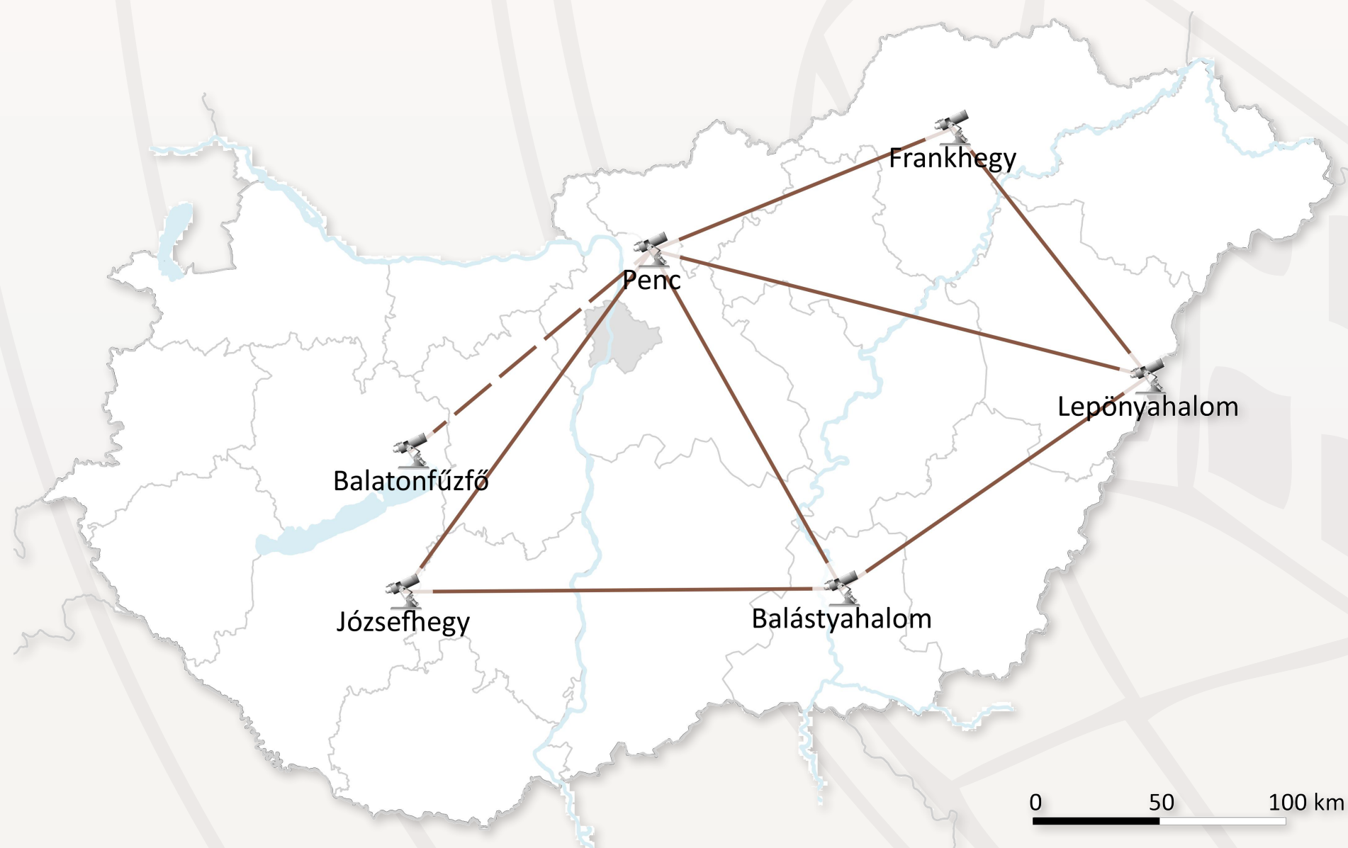
A mintegy 200 km oldalhosszúságú stelláris hálózat lehetőséget nyújtott az I. rendű hálózat tájolásának és torzulásának ellenőrzésére.
