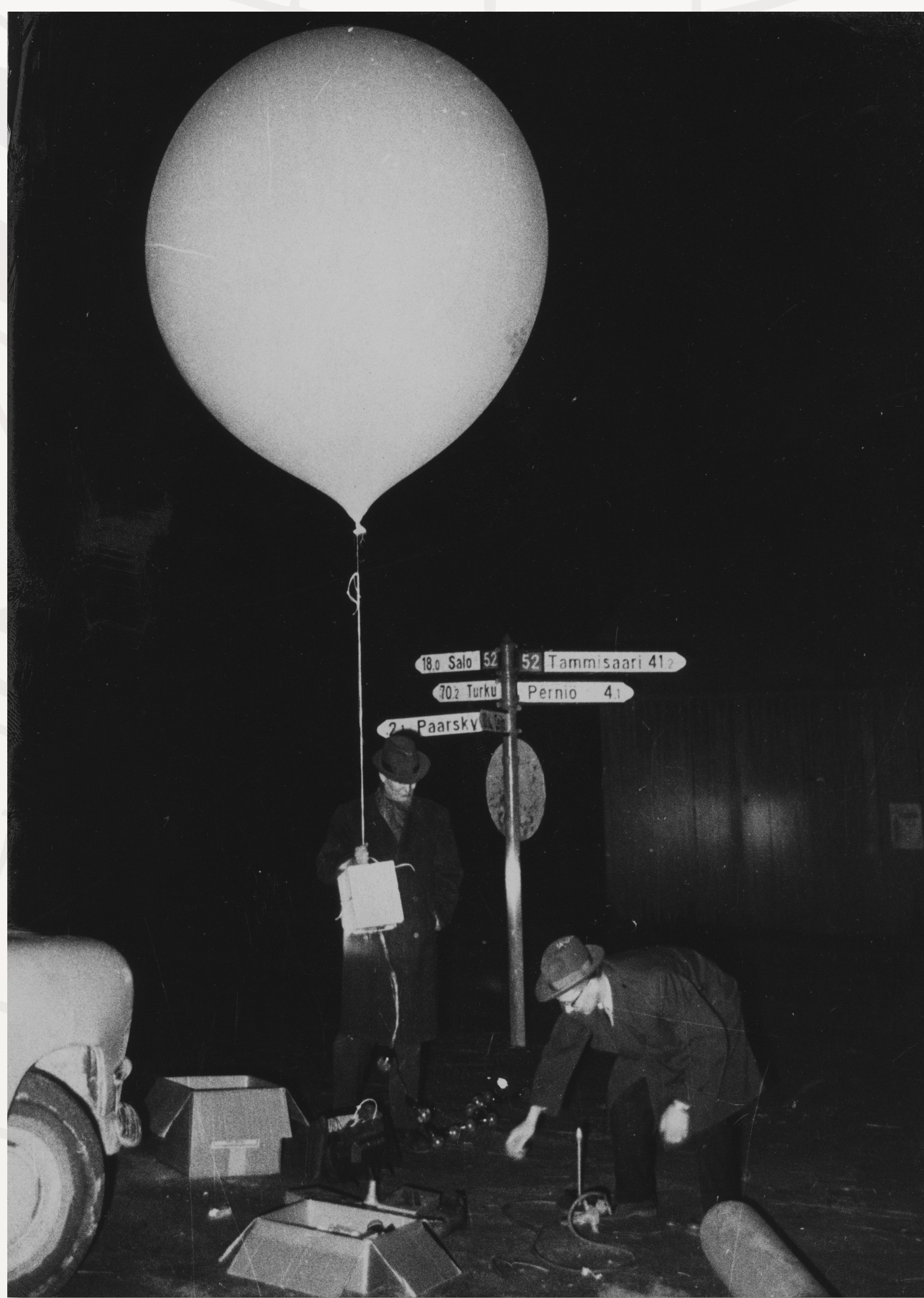
Szonda indítása a finnországi hálózat mérésében
